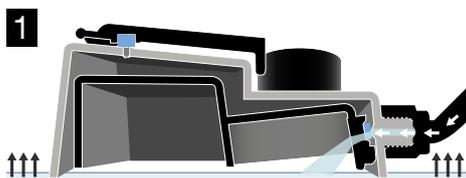
Une fois que l'AQUAvalve est placée dans un plateau, qu'elle est reliée à l'alimentation en eau et que le robinet est ouvert, l'eau va commencer à couler dans le plateau au travers de la buse de l'AQUAvalve. Le flotteur interne va se soulever quelque peu mais le flotteur supérieur restera en position, maintenant ainsi l'ouverture sur le corps principal fermée et empêchant ainsi le flotteur interne de se soulever davantage.
