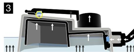
Une fois que l'eau atteint un niveau de 20 mm (à mi-chemin au niveau de la bague d'arrêt de l'AQUAvalve), le flotteur supérieur va se soulever, permettant ainsi à l'air piégé à l'intérieur du corps principal de s'échapper. Le flotteur interne va se soulever simultanément et couper l'arrivée d'eau.
